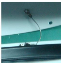
11. Совместите 3 отверстия для болтов с отверстиями на корпусе, ввинтите 3 болта М3 и затяните при помощи небольшой отвертки, входящей в комплект поставки, чтобы закрепить прозрачный купол.
